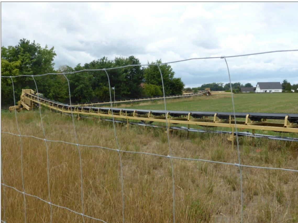
**Abb. 5** Bandstraße vom Abbaugelände „Siekkrug 2“ zum bestehenden Kieswerk (Juli 2022)
